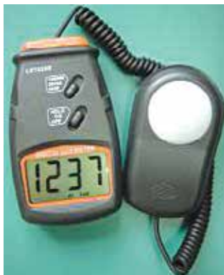
شکل ۱۱ - نمای دستگاه ثبت شدت نور در فضای گلخانه
